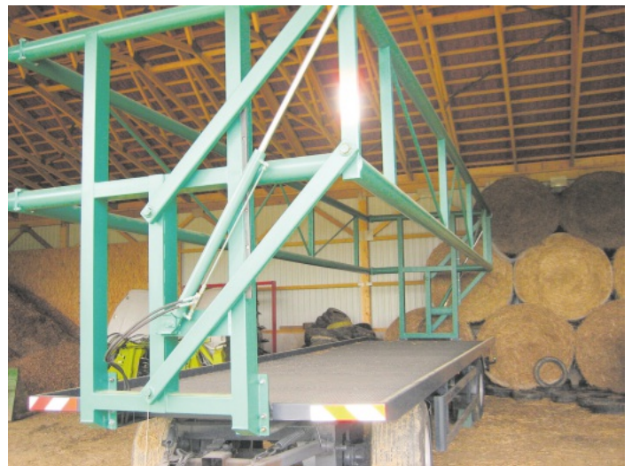
Durch hydraulische Bordwände ist ein Besteigen des Ballentransportwagens nicht mehr nötig.
